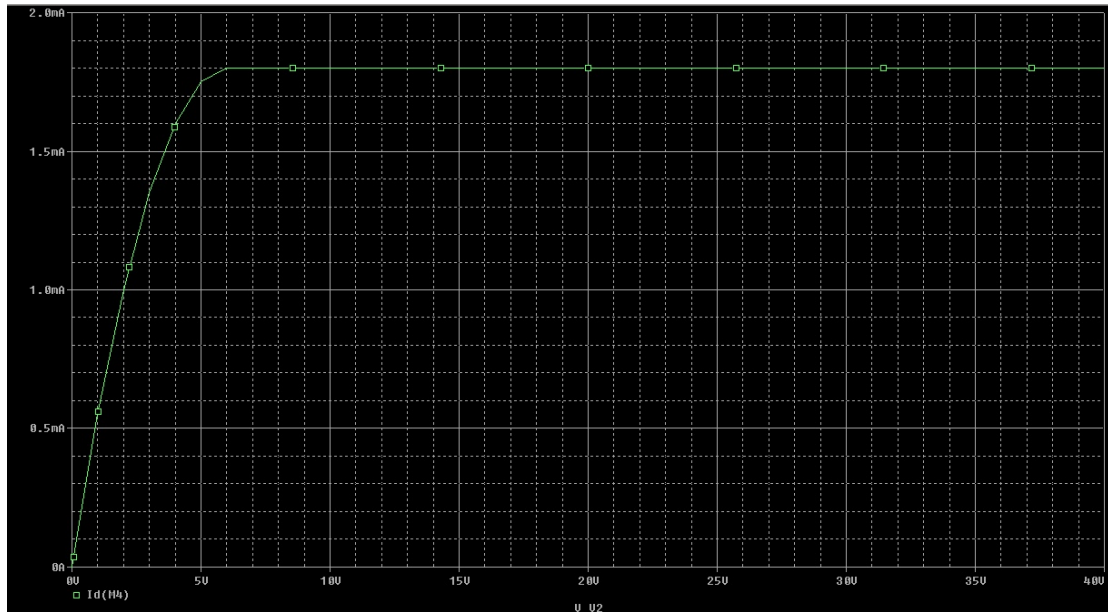
Εικόνα 72: Χαρακτηριστική I_D - V_{DS} με τάση V_{GS}=5V .
