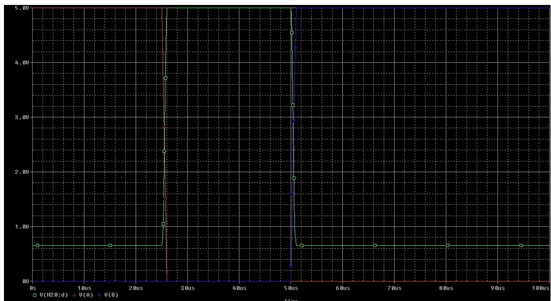
Εικόνα 77: Λειτουργία της πύλης NOR.
